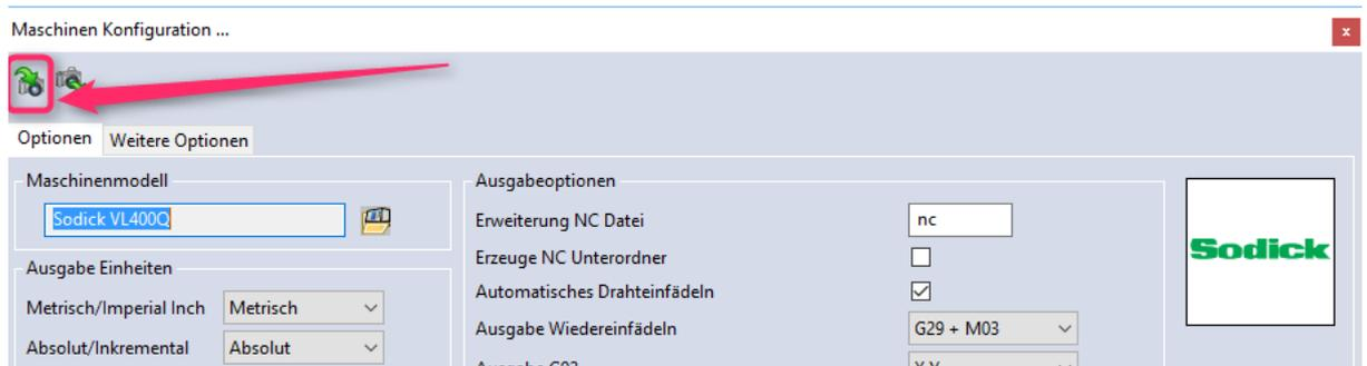
Starten Sie nun VISI2018 R2, erzeugen und öffnen ein neues PEW Projekt mit der benötigten Maschine. Verwenden Sie dieses Icon, alle gesetzten Optionen und Einträge werden aus der gespeicherten \*.SNP Datei in die Maske der Maschinenkonfiguration in VISI2018R2 übernommen.
